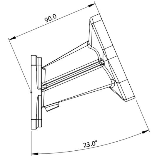
A LIGHTWEIGHT CAST ALUMINIUM INLET MANIFOLD FOR THE SUZUKI SWIFT / IGNIS M15A AND M16A ENGINES.
