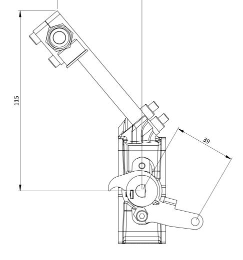
ABOVE DRAWING SHOWS MEASUREMENTS FOR 'LONG' BOSCH STYLE INJECTORS W/ RIGHT HAND LEVER FITTED
